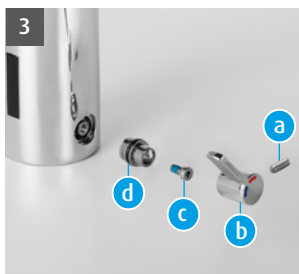
3. Griffschraube (a) mit Inbus 2,0 herausdrehen, Mischergriff (b) abnehmen, Adapterschraube (c) mit Inbus 2,5 lösen und Adapter (d) abmontieren.
