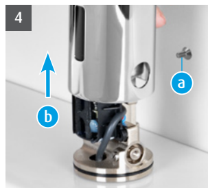
4. Sicherungsschraube (a) mit Inbus 2,5 auf der Rückseite der Armatur lösen und Armaturenhäube nach oben abziehen (b).
