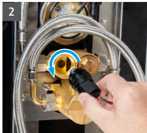
Magnetventil mit der Hand gegen den Uhrzeigersinn heraus-schrauben.
