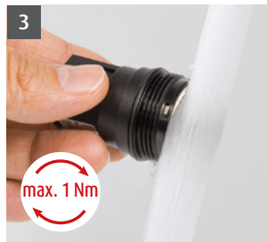
Ventilfilter unter fließendem Wasser reinigen (evt. weiche Bürste verwenden), ggf. Ventil tauschen. Magnetventil \leq 1 Nm Anzugsmoment per Hand einschrauben und Montage durchführen ( siehe Seite 13 ).
